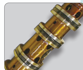
Ventilkolben mit Varnish
