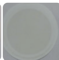
Patch test (MPC) DOPO LA manutenzione dell'olio con CJC®
