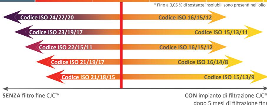
In 5 mesi la classe di pulizia dell'olio di 5 riduttori di turbine eoliche è migliorata da 5 fino a 8 classi ISO! Questo significa un aumento allungamento della vita utile di un fattore 2 fino a 3!
