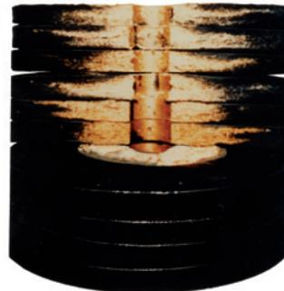
Sezione di una cartuccia filtrante di profondità CJC™ utilizzata.
