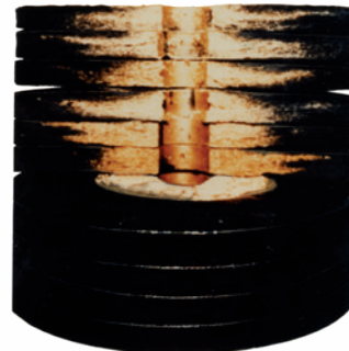
Querschnitt einer gebrauchten CJC® Tiefenfilterpatrone
