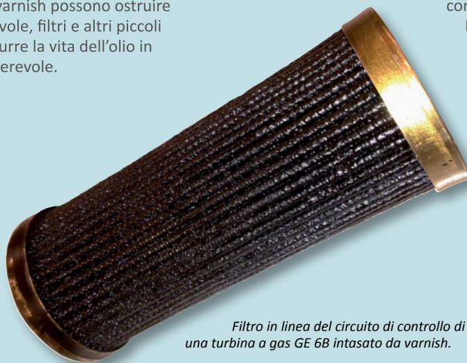
*Filtro in linea del circuito di controllo di una turbina a gas GE 6B intasato da varnish.*
