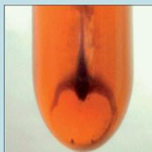
Ultracentrifuga, Campione all'uscita del VRU dopo solo un passaggio
