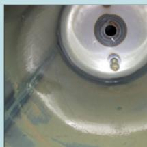
DOPO dell'avviamento del VRU: i depositi di varnish sono stati rimossi dalle superfici metalliche
