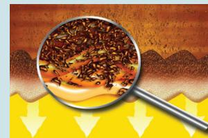
*La cartuccia di filtrazione fine pulisce l'olio fino a completa saturazione delle fibre.*
