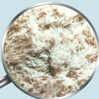
La struttura delle cartucce filtranti CJC™ è paragonabile ad un letto filtrante di grande volume e spessore, composto da un labirinto tridimensionale di canali finissimi collegati tra loro. Il 75% del volume della cartuccia è vuoto e ciò comporta una elevatissima capacità di accumulo di impurità.
