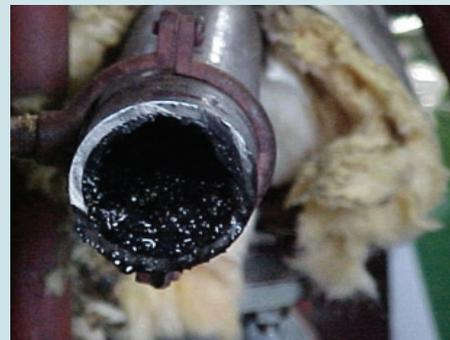
***Le principali cause di queste anomalie sono riconducibili ai prodotti della degradazione dell'olio che si possono eliminare con una filtrazione fine.***
