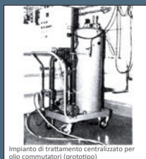
Impianto di trattamento centralizzato per olio commutatori (prototipo)
