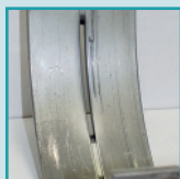
Formazione di righe a causa dell'abrasione
