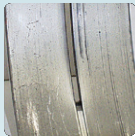
Righe a causa dell'abrasione (Bronzina)
