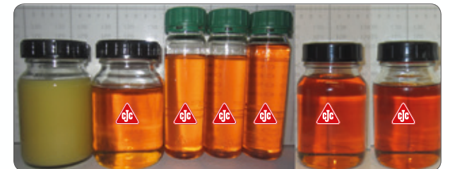
PRIMA della filtrazione, Dopo la 1 settimana filtrazione, Dopo la 4 settimane filtrazione, Dopo la 8 settimane filtrazione, Dopo la 9 settimane filtrazione, Dopo la 14 settimane filtrazione, Dopo la 16 settimane filtrazione
