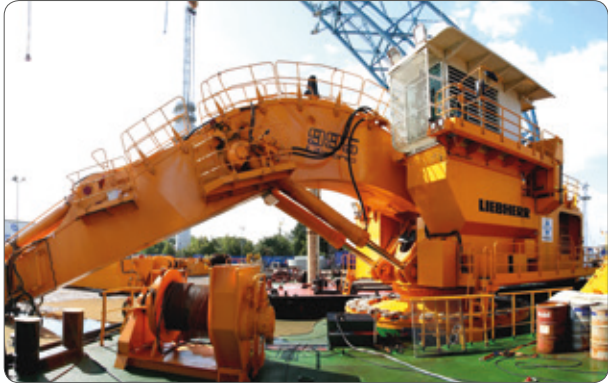
Escavatore di pontoni Liebherr P 995 Litronic - in uso durante la costruzione del porto per containers a Wilhelmshaven.
