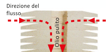
Corpo della cartuccia (Sezione trasversale) - L'olio scorre nella cartuccia filtrante di profondità CJC™ radialmente dall'esterno verso l'interno.
