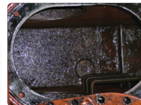
Serbatoio del gasolio con forte presenza di sporco, fango e acqua
