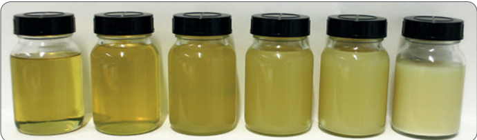
Hydraulikölproben mit unterschiedlichem Wassergehalt. Von links: 0,01 % - 0,03 % - 0,06 % - 0,1 % - 0,2 % - 2 % Wasser im Öl
