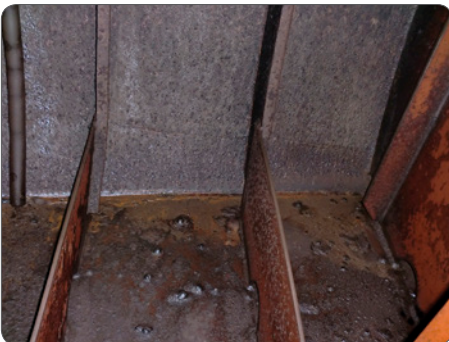
Extrem starke Bildung von Mikroorganismen im Dieseltank
