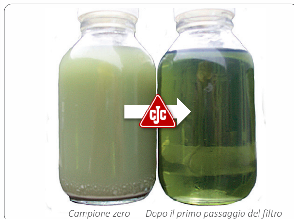
Campione zero Contenuto acqua: 702 ppm Classe di pulizia: 15/14/11
