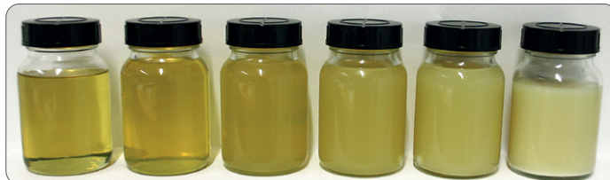
Campioni di olio idraulico con diverso tenore di acqua.
