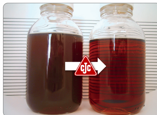
Campioni di oli sinistra: campione zero, giusta: con filtro lubrorefrigerante CJC®
