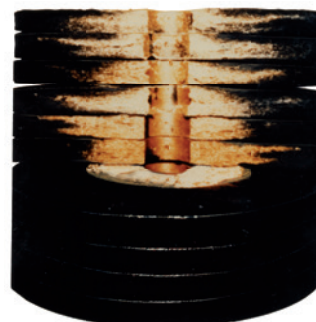
Sezione di una cartuccia filtrante di profondità CJC™ utilizzata.
